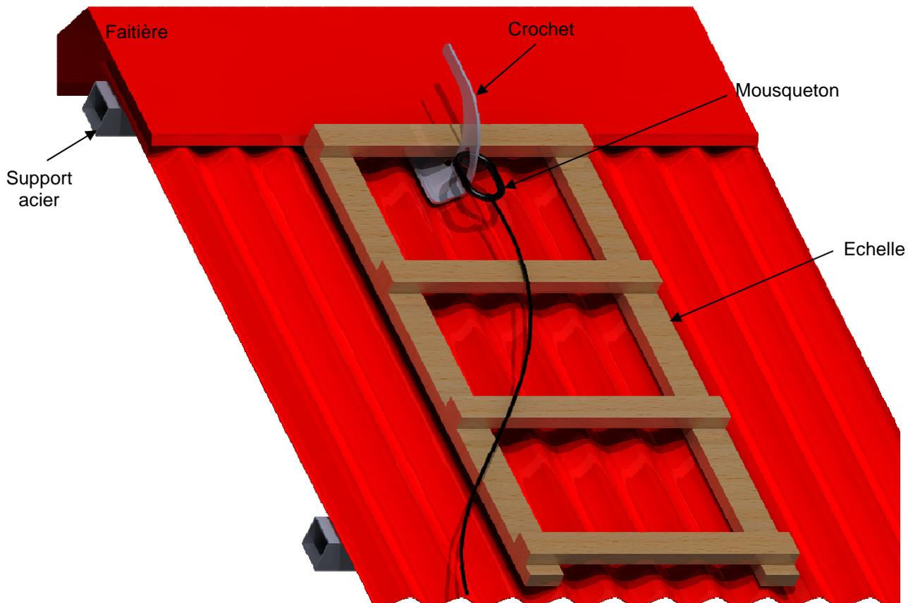
*La faitière recouvrira en grande partie le crochet, assurant une protection complémentaire contre les infiltrations.*
