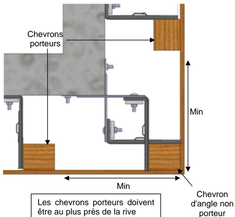
**IMPORTANT :** Les chevrons porteurs doivent être placés au plus près des rives afin de soulager le chevron d'angle, des charges de vents et de poids propre du bardage.
