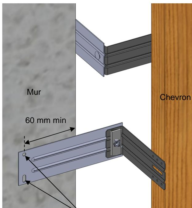
Fixation des platine d'angles sur le mur à l'aide de 2 chevilles M8
