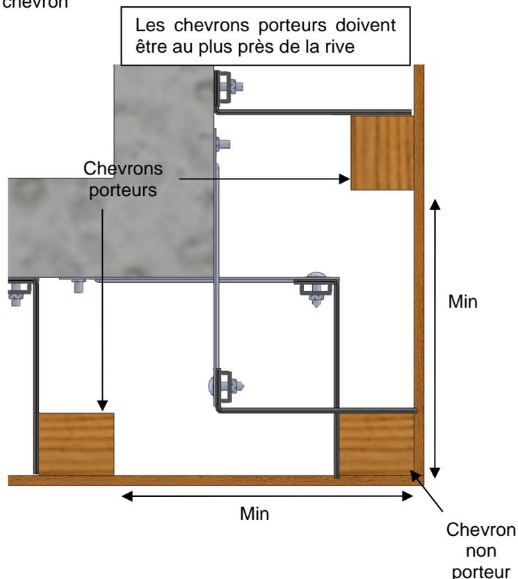
**IMPORTANT :** Les chevrons porteurs doivent être placés au plus près des rives afin de soulager le chevron d'angle, des charges de vents et de poids propre du bardage.
