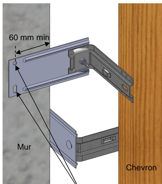
Fixations des platines d'angle sur le mur à l'aide de 2 chevilles M8
