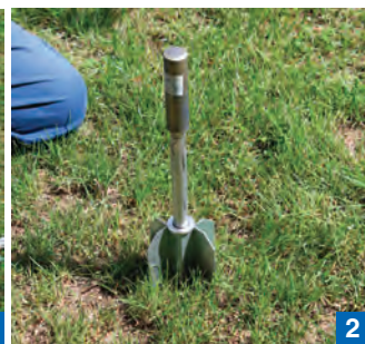
Enfoncement de l'amarre à l'aide de l'outil d'enfoncement.
