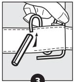
3 Blocage du tendeur à l'aide du tube en aluminium pour obtenir la tension souhaitée.
