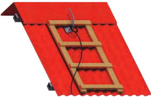
Crochet de sécurité en inox ou galvanneal pour tôle ondulée.
