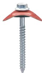
Tirefond à visser tête hexagonale à embase galvanisé à chaud + plaquette TOG + rondelle néoprène assemblés 3 en 1 pour pannes bois
