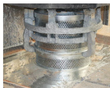
Pièces trempées dans le bain de zinc.
