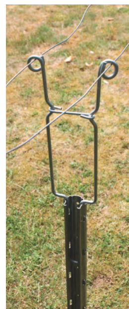
Rehausse sur piquet métallique profilé.
