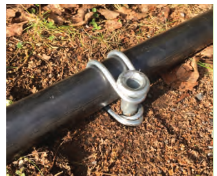
Tube fixé à l'aide de l'attache en fil et de l'amarre.
