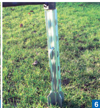
6 Enfoncer le stabilisateur dans le sol à l'aide de l'outil.
